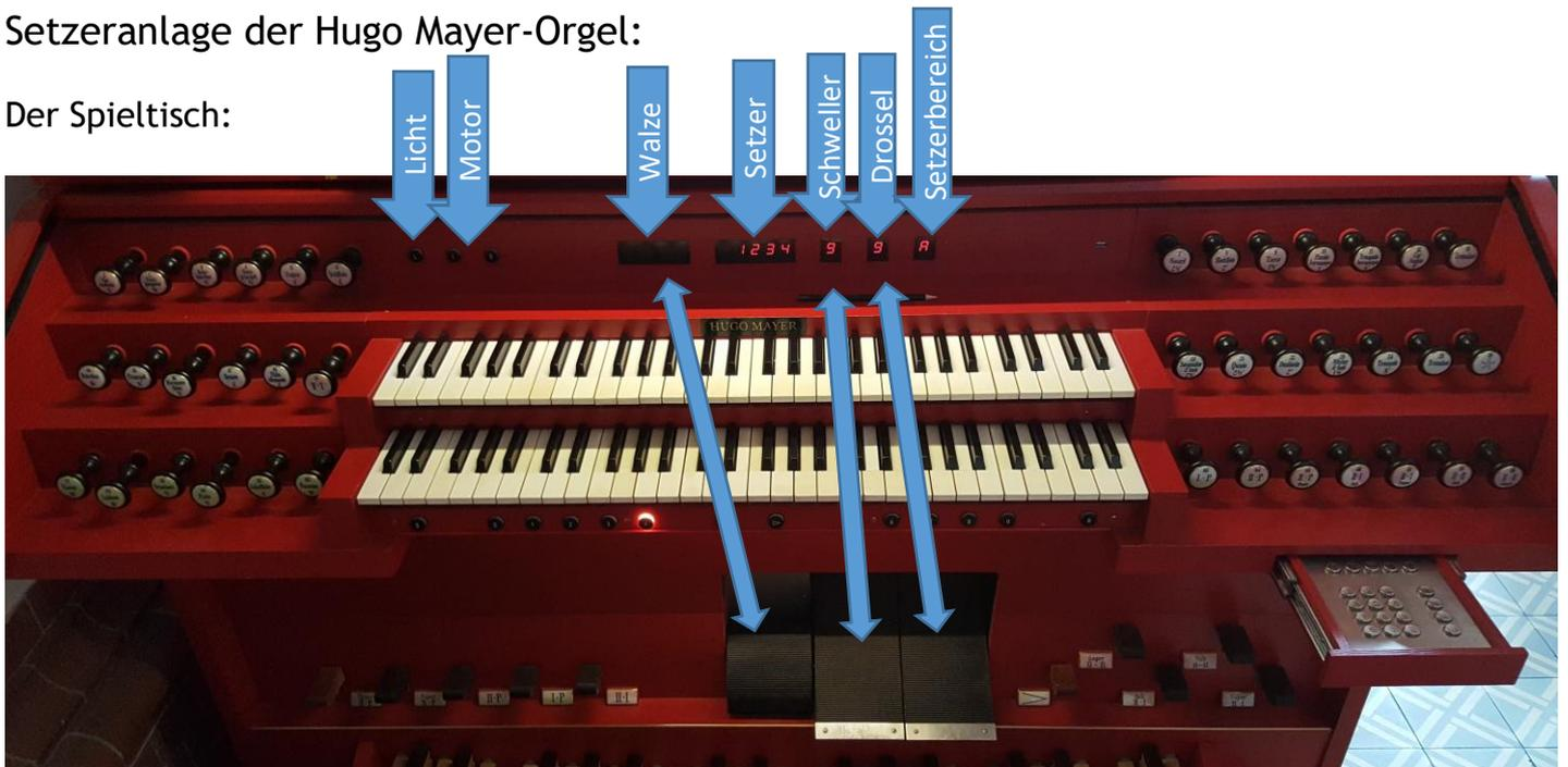
Walze und Drossel werden bei Bedarf eingeschaltet, der offene Setzerbereich ist ohne Anzeige
